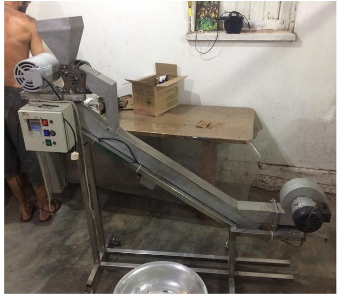
*Detektivarbeit um passende Geräte zu finden: diese selbstgebaute Maschine trennt die Schale von den Kakaobohnen*
